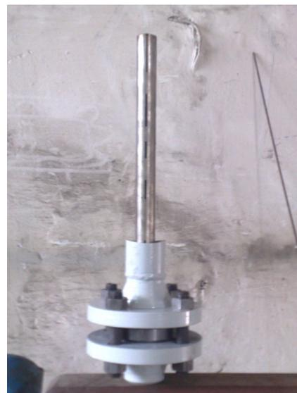
ПРОБОЗАБОРНОЕ УСТРОЙСТВО ЩЕЛЕВОГО ТИПА
