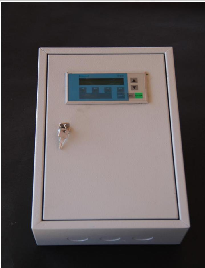
Вторичный прибор – блок вычислений (БВ) должен иметь шкаф, где размещены контроллер для вычислений, аналого-цифровой преобразователь, барьеры искрозащиты
